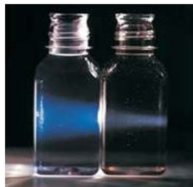
Ilustración 4.28. Un rayo de luz que atraviesa un coloide es dispersado debido al tamaño de las partículas. El reflejo de la luz sobre las partículas coloidales pone de manifiesto el recorrido de la luz; es lo que se conoce como efecto Tyndall (Fuente: www.cneq.unam.mx ).
