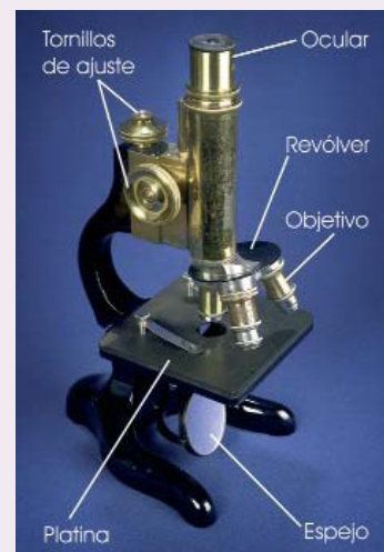
Ilustración 1.5. Microscopio óptico compuesto, modelo Leitz-Wetzlar de 1913. (Fuente: http://phil.cdc.gov/phil )
