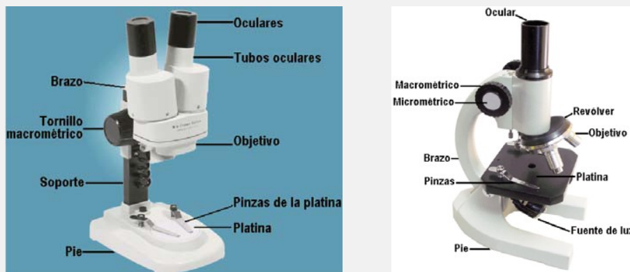
Figura 2.31. A la izquierda, lupa binocular. A la derecha, microscopio de laboratorio. En ambos casos se muestran sus principales componentes. Al girar el tornillo macrométrico el objeto se aleja o se acerca. El tornillo micrométrico permite enfocar la imagen
