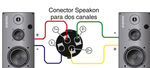
Figura 6.43. Uso de un solo conector Speakon para dos canales.
