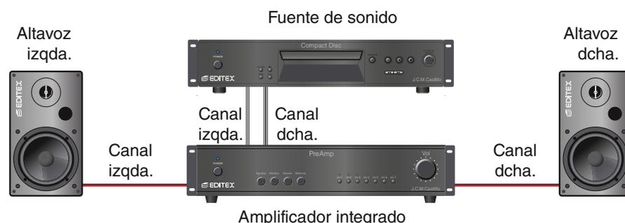
Figura 6.7. Configuración de un sistema de sonido con amplificador estereofónico.
