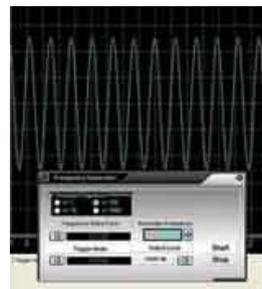
Por otra parte existen programas dedicados al estudio de las señales audio como el **software RIGHTMARK**, el cual es un **analizador y banco de pruebas** para audio. La señal de salida de los equipos de audio se introduce en la entrada de la tarjeta de sonido del **PC**. Con este programa podemos analizar la respuesta en frecuencia de los amplificadores, la figura de ruido, la distorsión armónica total, la diafonía entre los canales estéreo, entre otros parámetros.
