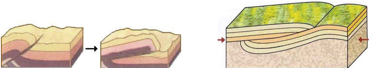
Figura 10.38. Izquierda: formación de un pliegue-falla. Derecha: cabalgamiento. En ambas estructuras ocurre una superposición e incluso inversión de parte de la serie estratigráfica alterando el orden de superposición original de la misma.
