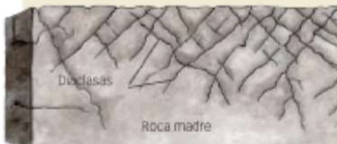
Doc. 26 Mecanismo de actuación de la erosión mecánica sobre el granito.
