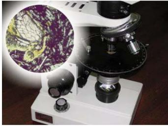
**Figura 9.18.** *Microscopio petrográfico (en el círculo se puede observar una muestra).*
