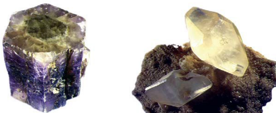
Figura 8.9. El aragonito y la calcita son polimorfos: los dos tienen la misma composición química ( \text{CaCO}_3 ), pero sus cristales difieren. En el primer caso (fotografía izquierda) se generan prismas rómbicos que con frecuencia se unen para dar prismas hexagonales cuando hay altas presiones y temperaturas, soluciones concentradas y alto contenido en magnesio; en el segundo caso se forman romboedros cuando las condiciones de presión, temperatura, concentración de sales y contenido en magnesio son bajas.
